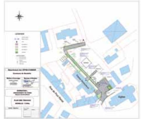
Travaux de sécurisation du carrefour entre la rue d'Armor et la route de Tressignaux. Création d'un rond-point afin de limiter la vitesse en entrée de bourg, et d'un agencement permettant une meilleure visibilité pour les automobilistes qui viennent de la route de Tressignaux. Effacement des réseaux électriques sur toute la portion concernée.
